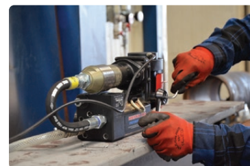
Toevoer hendel kan aan beide zijden gebruikt worden
