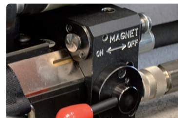
Bescherming tegen starten van de motor wanneer de magnetische basis niet is geactiveerd
