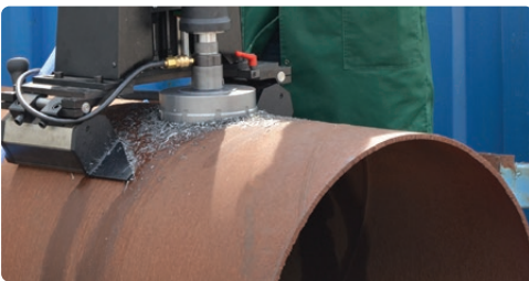
PRO-200A ATEX kan gemonteerd worden op buizen van min. 950mm (37.4") diameters.
