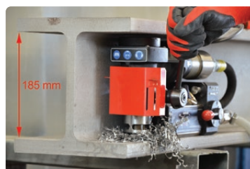
Compact ontwerp voor werken in beperkte ruimte
