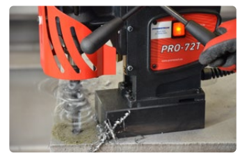
Spiraalboor max 25 mm (1") Max slag tot 190 mm (7-1/2")
