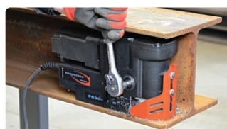
Compact ontwerp voor ruimtes met beperkte hoogte. Afneembare ratelsleutel kan aan beide zijden worden gebruikt.
