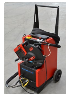
Draagbaar hydraulisch persstation met legbord voor het transport van de ponsmachine
